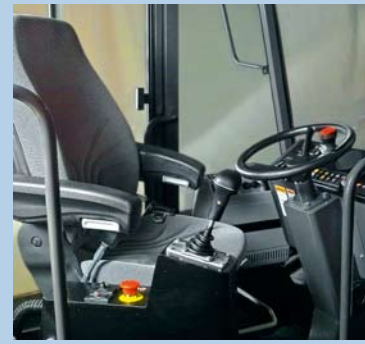
Puesto de conducción integrado con asiento giratorio
