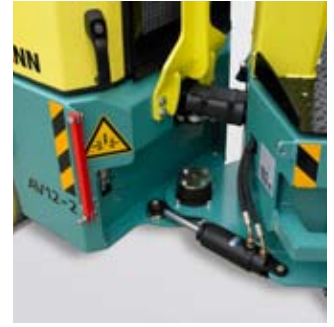
Articulación central lubricada de por vida
