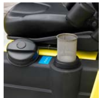
Sistema múltiple de filtración de agua
