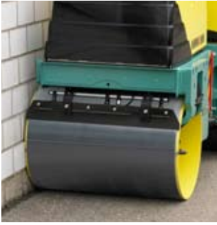
Compactación junto a paredes y esquinas
