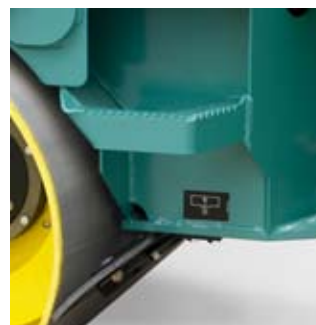
Puntos externos de drenaje
