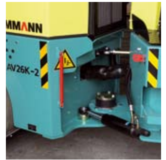
Articulación central lubricada de por vida
