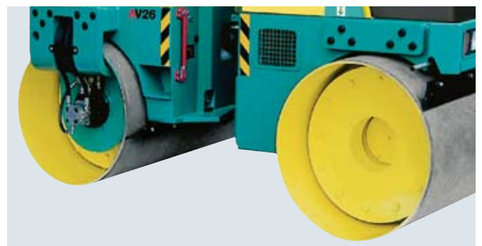
Los Rodillos Vibrantes Tándem AV 23-2/26-2 y AV 23-2K/26-2 K están disponibles en modelo con los laterales sin salientes
